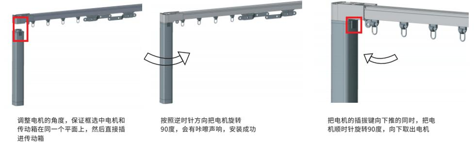
调整电机的角度, 保证框选中电机和传动箱在同一个平面上, 然后直接插入传动箱
